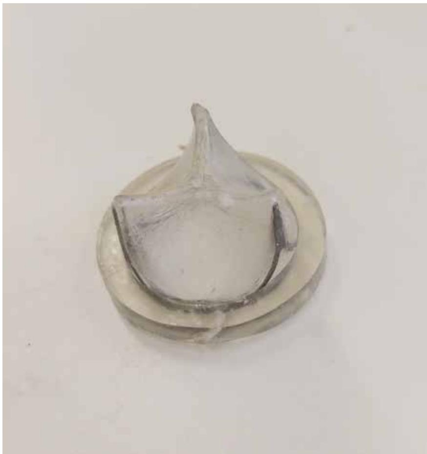
**Prothèse de valve cardiaque obtenue par moulage par injection de PHOx**
