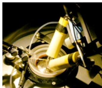
Dispositif de pincettes magnétiques permettant d'appliquer un champ électromagnétique localisé sur des billes paramagnétiques de quelques microns de diamètre afin d'accéder à une gamme de forces allant du piko au nano-Newton.
